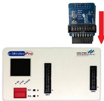
图 4. e-WriterPro 连接 EMDE001A
