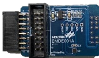
图 3. Holtek 温度校正工具 EMDE001A
