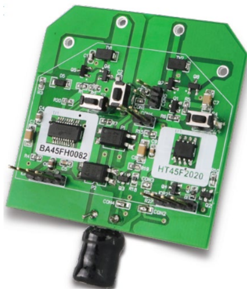
图 2. 联网型声光报警器成品图
